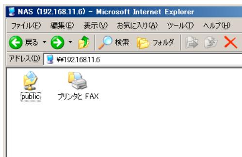
**Step 2** 正しく接続できた場合、ブラウザ上に本製品に接続されている USB デバイスを表す「public」フォルダが表示されます。
