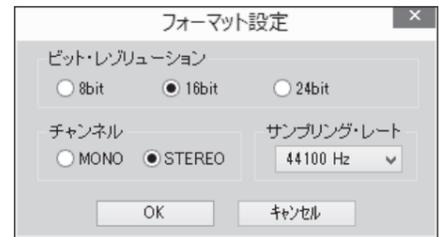
！ 選択できるサンプリング・レート（サンプリング周波数）は、4kHz～192kHzです。ビット・レゾリューション（量子化ビット数）は、8、16、24ビットです。サンプリング・レートが高いほど高音域の周波数特性は良く、ビット・レゾリューションが高いほどダイナミックレンジは広がります（反面、ファイルサイズは大きくなります）。音楽CDの場合、サンプリング・レートは44.1kHz、ビット・レゾリューションは16ビットです。高いサンプリング・レートで録音する場合、ファイルのサイズが大きくなり、より多くのディスクスペースが必要となります。保存先のハードディスクの空き容量には十分注意して設定してください。PCA-ACUP3では最大で16bit 48000Hzまでの取り込みに対応しております。上記を超えるビットレート、サンプリングレートで録音を行っても効果は得られません。
