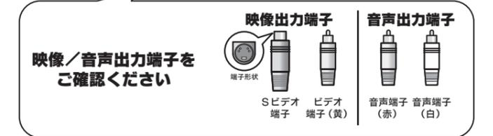
映像出力機器の音声端子(赤/白)を本製品の音声入力端子に接続します。
