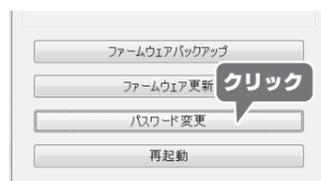
[新パスワード]にパスワードを入力して、確認のため同じパスワードを[新パスワード確認]に入力します。入力後、[確認]をクリックするとパスワードが設定されます。
