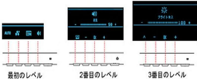
5つの操作ボタンは、本体正面の下部にあります。設置が完了した後、一番右にある①電源ボタンを押して電源をオンにします。
