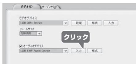
「入力」をクリックして3.5mmステレオミニプラグのパソコンの接続先を選択します。マイク端子に接続した場合は「マイク」を選択します。
