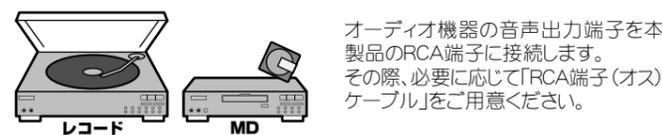
オーディオ機器の音声出力端子を本製品のRCA端子に接続します。その際、必要に応じて「RCA端子（オスケーブル）」をご用意ください。
