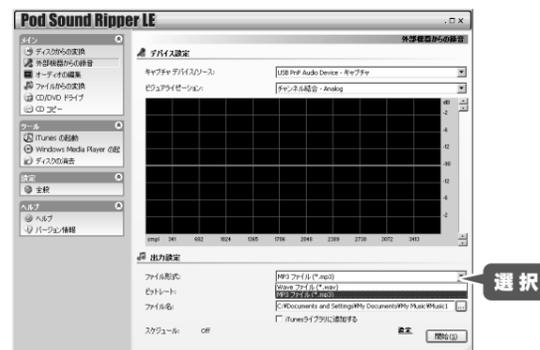
[ ビットレート ] をクリックして、録音データのビットレートを選択してください。
