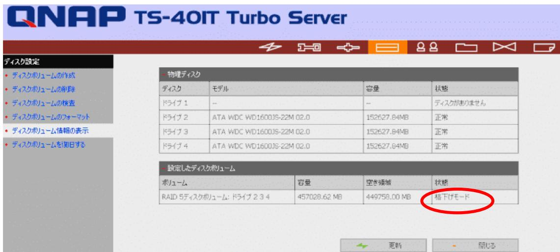
7. 外していた HDD を再装着します。システムが HDD を認識するとリビルドが開始されます。リビルドのプロセスが 100% になれば完了です。この時、再装着した HDD に物理的な破損や電気的な故障がある場合、リビルドを完了することができません。この場合は HDD を交換して再装着してください。
