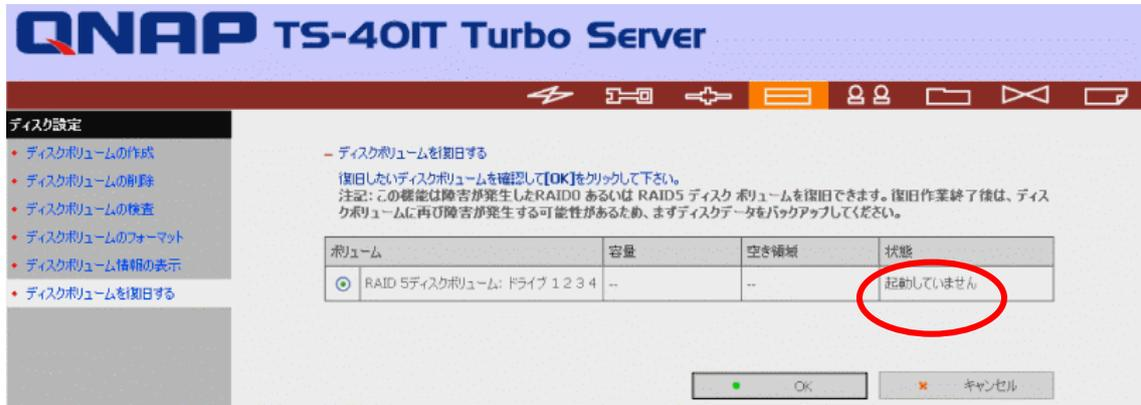
3. 復旧の障害となる HDD が存在した場合、次のような画面が表示されます。該当する HDD を一旦外し、[戻る]をクリックして「ディスクボリュームを復旧する」の画面に戻ります。
