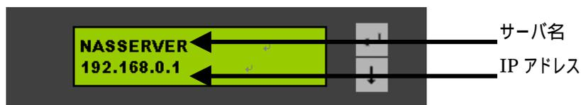
DHCP プロトコルがサポートされていないネットワークの場合は、本製品を最初に使用する前に適切な LAN 設定にする必要があります (LAN 設定が不明の場合は、ネットワーク管理者に確認してください)。
