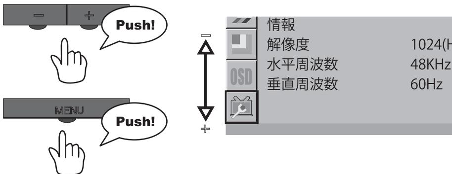
③ +-ボタンで変更したい項目を選択して、MENU ボタンで実行してください。選択項目が赤字で表示されたら、+-ボタンで設定を変更し、MENU ボタンで実行してください。
