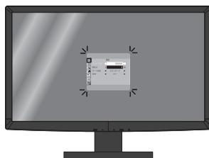
②設定画面左上のアイコンに赤枠が表示されています。赤枠に囲まれている部分が、現在選択されている設定項目です。+-ボタンで赤枠が上下に動きますので、調整したい項目のアイコンに合わせてください。設定したい項目が決まったら、MENU ボタンで実行してください。
