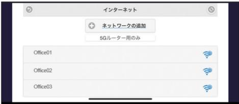
受信機（親機）を導入するネットワーク SSID を選択するか、「ネットワークの追加」を選択してログイン情報を入力してください。
