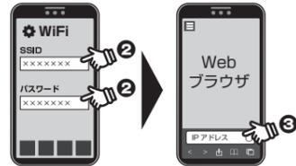
3. 受信機（親機）の WiFi に接続したスマートフォンまたはパソコンでブラウザを表示して、アドレスバーにホーム画面左下に表示されている「Direct LinkIP」の IP アドレス「192.168.168.1」（または http://192.168.168.1）を入力すると、Web 設定画面にアクセスできます。
